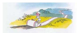
Lors d'une réparation de chaussée au « point-à-temps », l'ouvrier répand une émulsion de bitume et de gravillons. Cette technique permet un entretien de la surface de la chaussée en redonnant de l'étanchéité. Les réparations ne sont effectuées que sur des surfaces ponctuelles.
